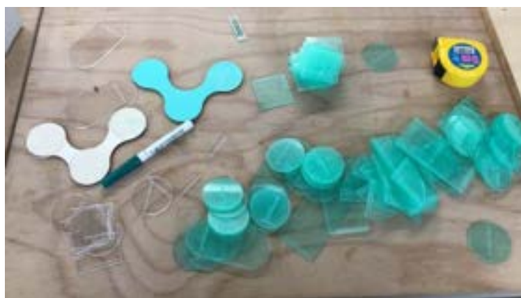
FIGURA 2 – PROTOTIPO INIZIALE DI GIOCO CON TESSERE DI FORMA ORGANICA E GEOMETRICA IN LEGNO E PLEXIGLASS, TAGLIATE CON LASER CUTTER E IN PARTE RIVESTITE CON PELLICOLA VINILICA ADESIVA TAGLIATA CON VINYL PLOTTER
